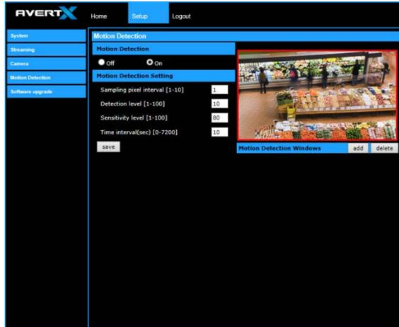
Dans la page détection de mouvement page, il y a une fenêtre détection de mouvement (case rouge) affichée dans la le volet de visionnement en direct. La fenêtre de détection de mouvement définit la zone de détection de mouvement. Pour changer la taille de la fenêtre de détection de mouvement, faites glisser le coin du cadre pour redimensionner.
